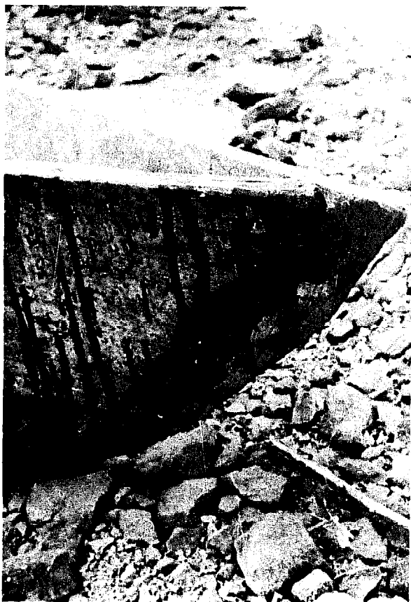
Fig.11 Ces planches de côté (bordés) sont en quelque sorte cousues ensemble par des clous ordinaires retournés. Le goudron est appliqué à l'extérieur plutôt que dans les joints
