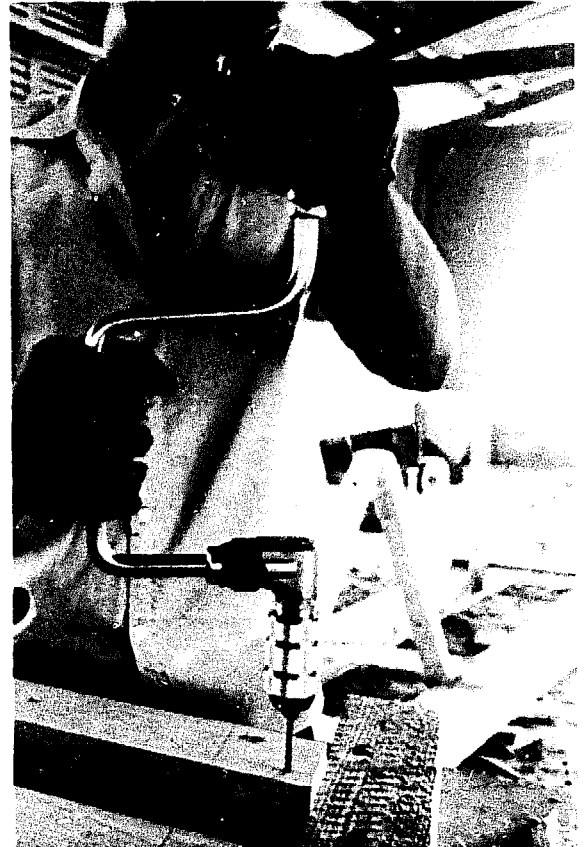
Fig.73 Percer les trous de 4 cm de profondeur avec un foret de 4 mm ou avec un clou dont la pointe a été aplatie à cette largeur. Laisser le foret dépasser de 4 cm du vilebrequin Fig.73 Drill 5 1/2" holes 1/2" deep either with a regular bit or a nail flattened to proper width. Let the bit protrude 1/2" from the drill
