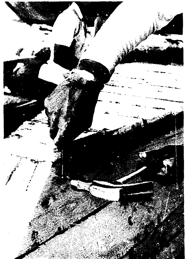
Fig.167 Sur le bouchain chasser les têtes de clous à proximité des planches de fond (avec la tête d'un clou de 10 cm)
