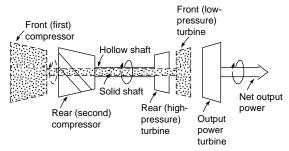
Fig. 9.7.17 Dual-spool gas-turbine component arrangement.
