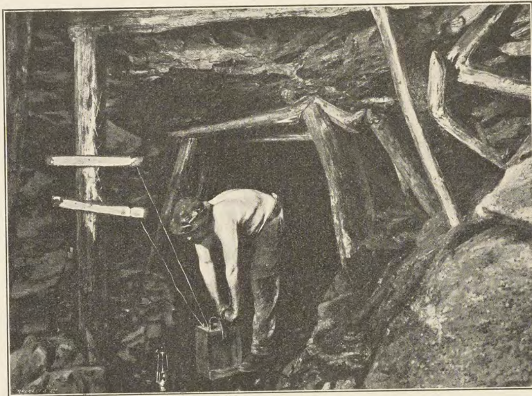
FIG. 158. — Tirage des mines par l'électricité: Ouvrier maniant l'exploseur.
