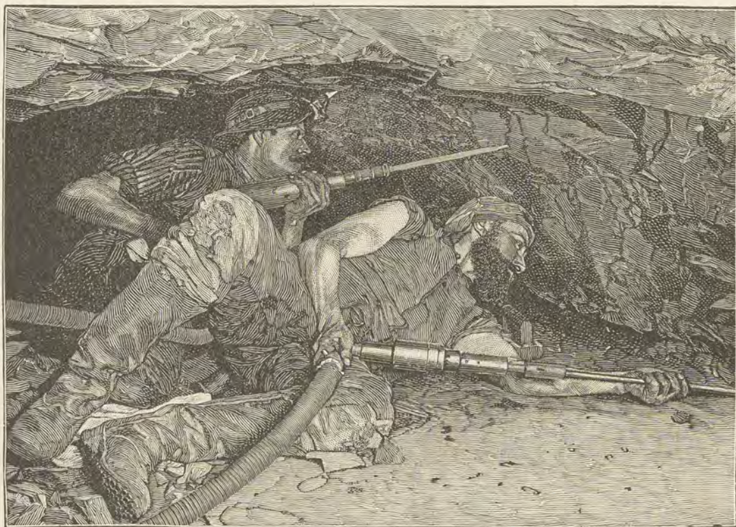
FIG. 161. — Perforatrices à bras au travail dans les mines de cuivre de Mansfeld.
