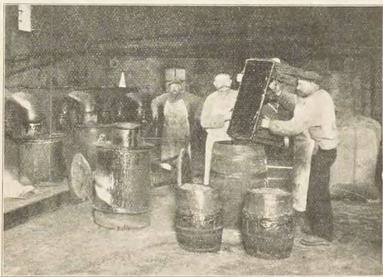
Abb. 25. Blick in die Schmelzfabrik in Palmnicken. Links die Retorten, rechts wird geschmolzener Bernstein (Bernsteintopphonium) in ein Faß gegossen. (Nach einer Photographie im Besitze der Bernsteinwerke Königsberg i. Pr.)
