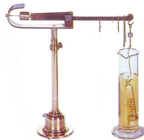
Fig. 107 Mohr-Westphal balance (Image by courtesy of Gassner Wiege und Messtechnik, Salzburg, AT)
