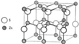
Fig. 18-1. The wurtzite structure.
