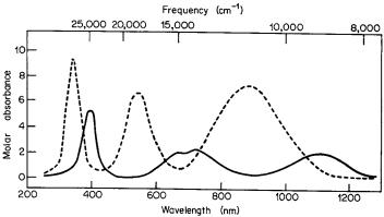
Fig. 25-G-1. Absorption spectra of  $[Ni(H_2O)_6]^{2+}$  (----) and  $[Ni\ en_3]^{2+}$  (----).
