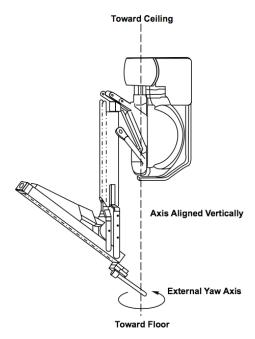
Fig. 17. The external yaw axis.
