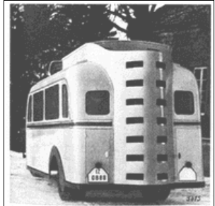
Bild 3. Omnibus mit 26 Sitzen und Holzgasantrieb. Besetzt Prof. Dr. Döberl. Die Generatoren im Heck erzeugen und verbrennen aus Kohlen. Die Luken in der Verkleidung dienen zur Füllführung und sind gleichzeitig Sauglöcher für das Induciergebläse. Zusätzlicher Heißwasser befindet sich auf dem Heckes Auslass über dem Dach. Fertigung der Teile und die Deckung der zu erwartenden Kraftstoffnachfrage.
