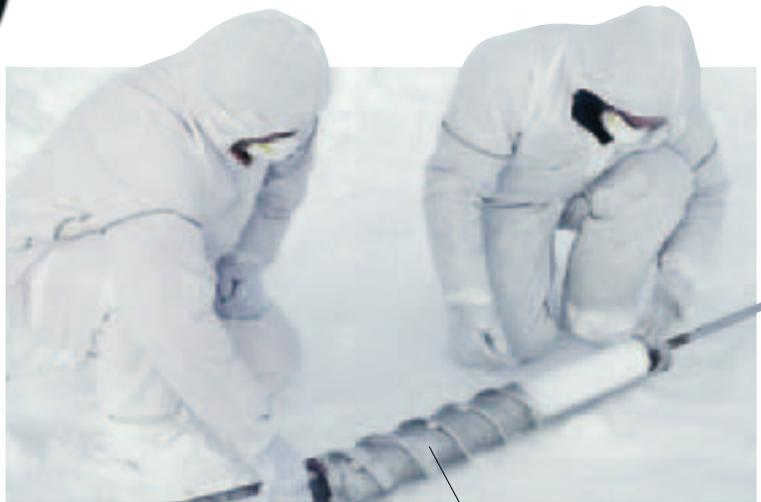
HOLLOW DRILL PIPE FOR EXTRACTING ICE CORE
