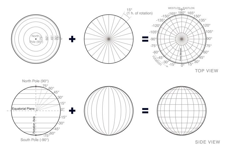
Figure 2.6 **Latitude and Longitude Construction** Grea Arcanaeli
