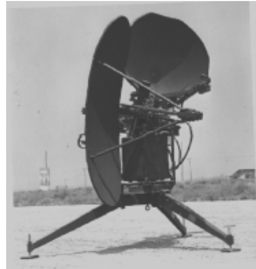
Figure R54 AN/TPN-18 X-band PAR antenna system (ITT Gilfillan Co. photo).
